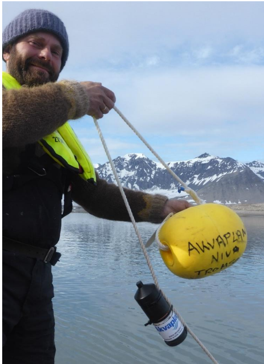
Figur 2. Rigg med logger (akustisk mottaker / lyttebøye). Foto: Akvaplan-niva.
